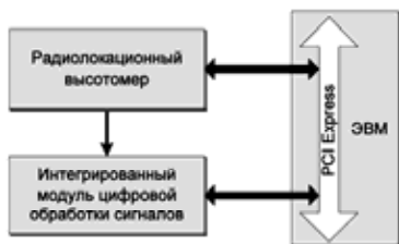
Рис. 5. Структурная схема системы корреляционно-экстремальной обработки
