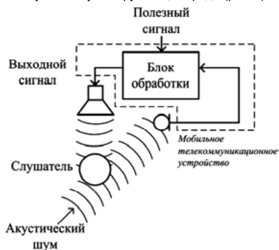
Рис. 2. Система для прослушивания сигнала в шумовой обстановке на основе мобильного телекоммуникационного устройства
